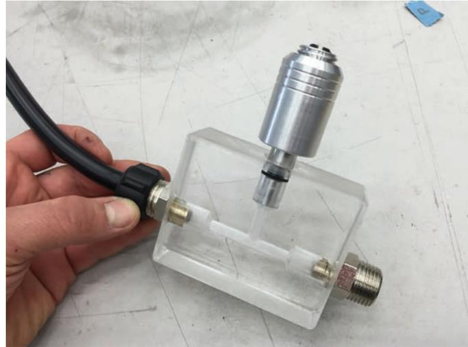
Die Kupplung verbindet den Reaktor mit dem Ventil und dem Sessel. Der Plexiglasblock hat drei Anschlüsse davon zwei mit 1/2" Gewindekupplungen.
