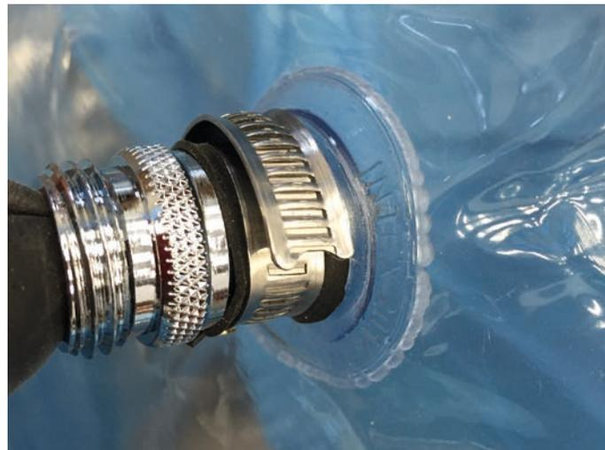
Eine Druckluft-Steckkupplung mit gummidichtung ergänz, dient als verbindung von Sessel zu Schlauch
