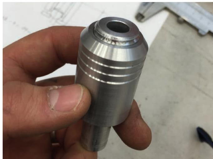
Kernstück der Konstruktion ist das einstellbare Überdruckventil. Das Ventil hat zwei Funktionen:
